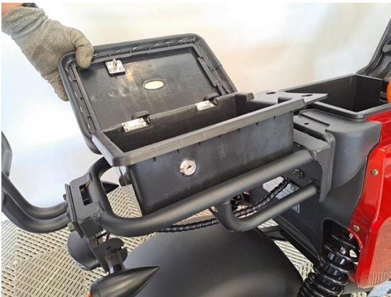
Nosta takaboksi paikoilleen.
