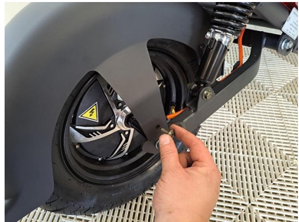
Kiinnitä takalokasuoja kupukantaisillapulteilla (kuusiokoloavain 5 mm).
