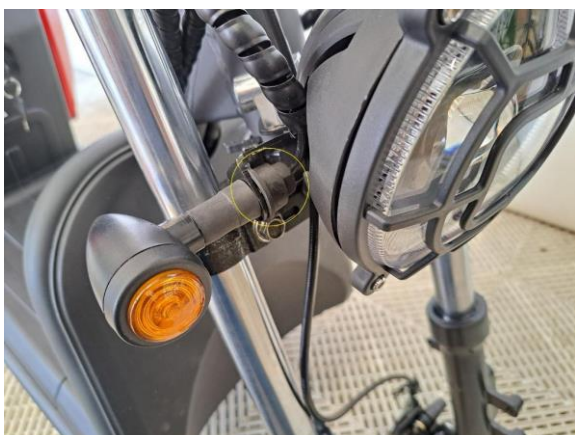
Aseta etuvilkun suojakumi kiinnitysmutterin päälle.
