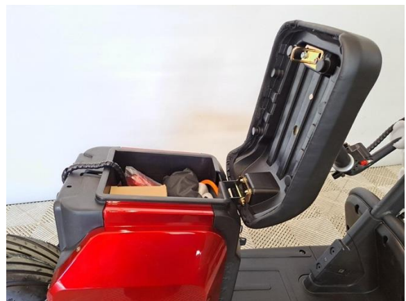
Penkinlukon avaimet on kiinnitetty nippusiteellä T-palaan. (katkoteräveisti).
