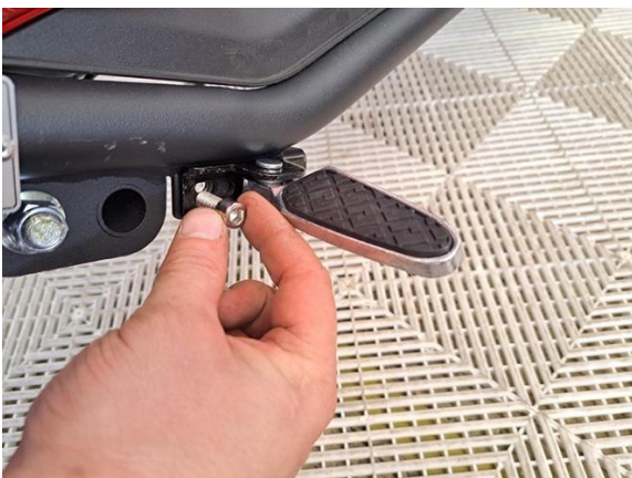
Kiinnitä takajalkatavat kiinnityspulteilla. (kuusiokoloavain 6 mm).
