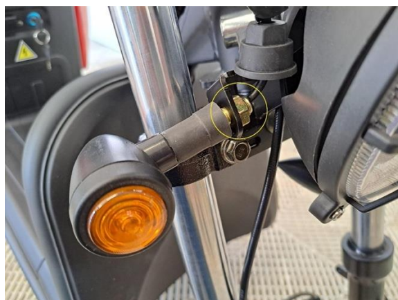
Kiristä etuvilkun kiinnitysmutterit. (kiintoavain 14 mm).
