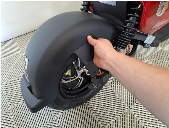
Aseta takalokasuoja Paikoilleen.
