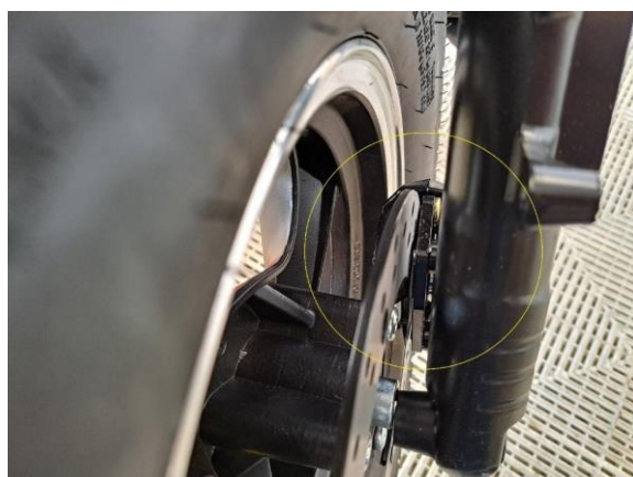
Nosta etupyörä paikoilleen. Katso, että jarru- levy asettuu oikein jarrupalojen väliin.
