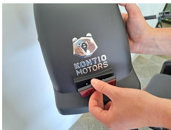
Laita takaheijastin takalokasuojaan kiinni.
