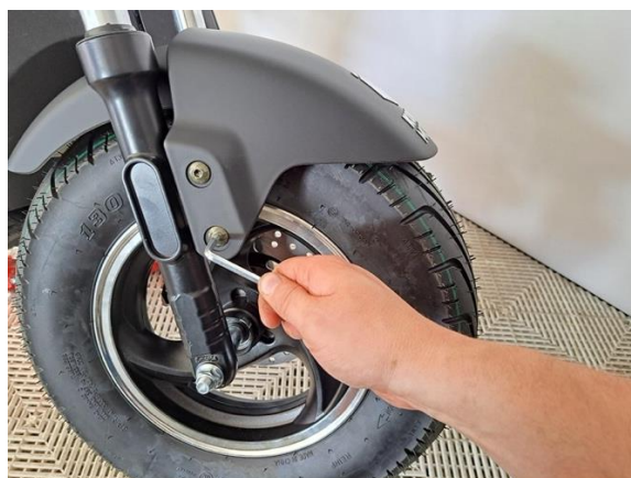
Kiinnitä etulokasuoja kupukantapulteille. (kuusiokoloavain 5 mm).
