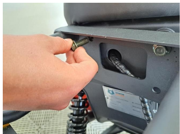
Kiinnitä tarakka kiinnityspulteilla. (kiintoavain 12 mm).
