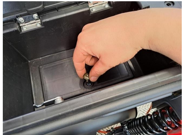
Kiinnitä takaboksi kupukantapulteilla ja kiinnitysmuttereilla. (kuusiokoloavain 5 mm kiintoavain 10 mm).
